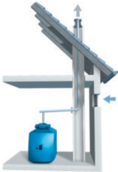
Raumluftabhängige Aufstellvariante mit eingezogenem Abgasrohr im Schornstein
