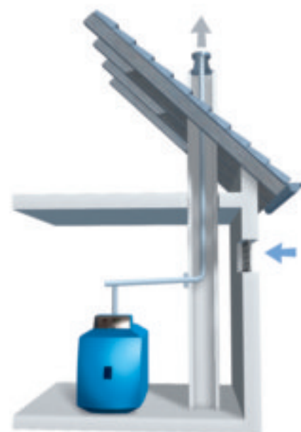
Raumluftabhängige Aufstellvariante mit eingezogenem Abgasrohr im Schornstein
