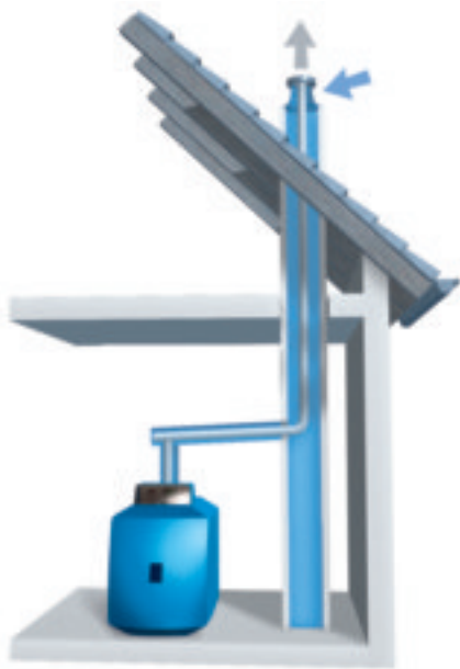
Raumluftunabhängige Aufstellvariante mit eingezogener Kunststoff-Abgasleitung im Schornstein
