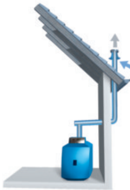
Raumluftunabhängige Aufstellvariante mit Rohr-in-Rohr-Kunststoff-Abgassystem entlang der Außenfassade
